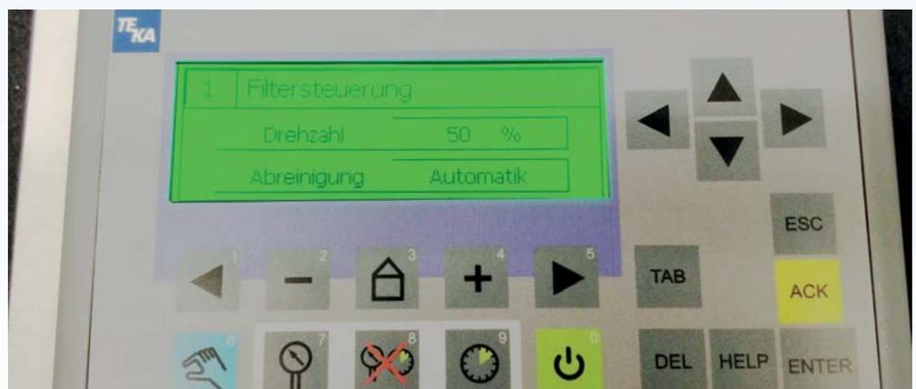
Integrierte Siemens S7-Steuerung
