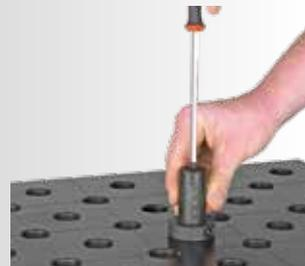
› Klemmung eines Vario Spannbolzen 28 S mit Innensechskantschlüssel
