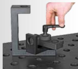
› Werkzeuglose Klemmung eines Vario Spannbolzen 28 K
