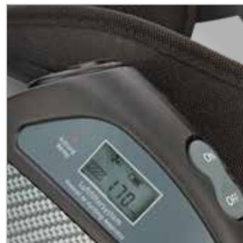
► LCD für Filter-, Batteriestatus und Luftfluss
