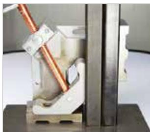
▶ gefräste Seiten zum Aufrechtstellen der Metallwinkelspanner
